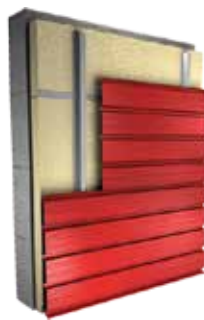
PRIMER FASADNE MONTAŽE
