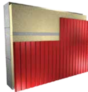
PRIMER FASADNE MONTAŽE
